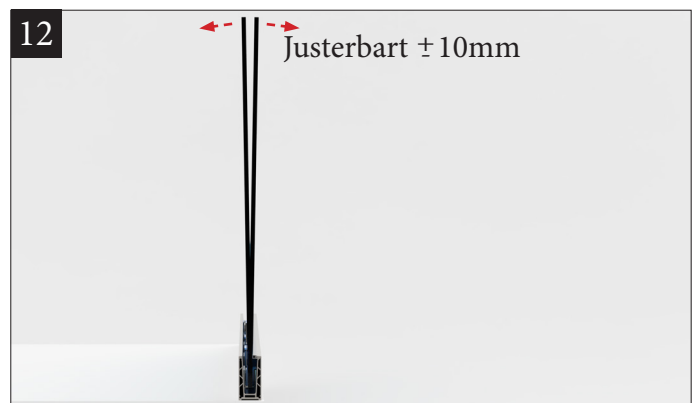
Nu kan du justera glasets lutning om det behövs. För ner justerverktyget i spåren mitt i glashållaren. För justerverktyget åt vänster eller höger för att justera lutningen. Justera lika och lite i taget på samtliga glashållare i profilen tills du uppnått rätt vinkel på glaset. För att underlätta justeringen kan man vicka på glaset i överkant samtidigt som man för verktyget åt önskat håll. Max justering på 1100mm är \pm 10 mm.
